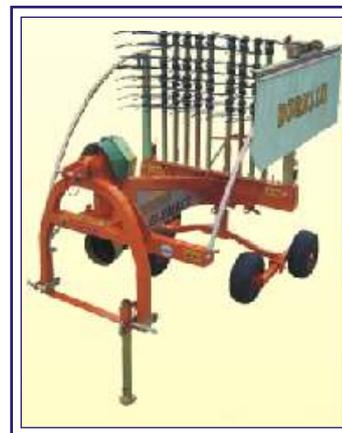
In versione BORELLO 3.5 S con telaio sterzante e assale tandem a bilancieri oscillanti garantisce la massima stabilità specialmente durante le lavorazioni su terreni sconnessi o irregolari
