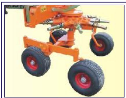
In versione BORELLO 3.5 F con telaio fisso si ottiene un ranghinatore molto stabile e di facile utilizzo in presenza di forti pendenze collinari o montane.
